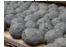
Fig. 16. Sample of Charcoal briquette
